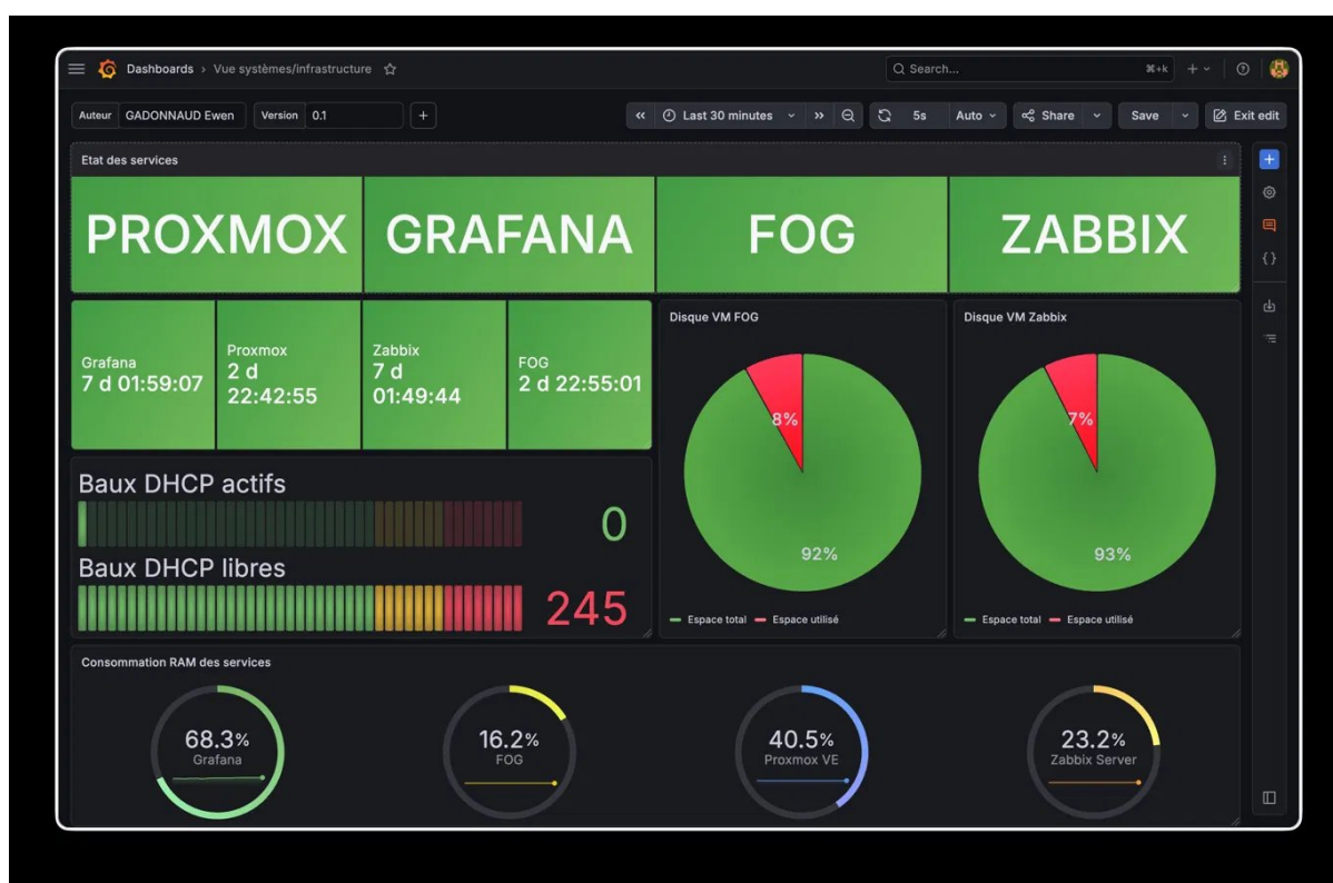
Capture du dashboard Services (états UP/DOWN, baux DHCP, uptime, disques)
