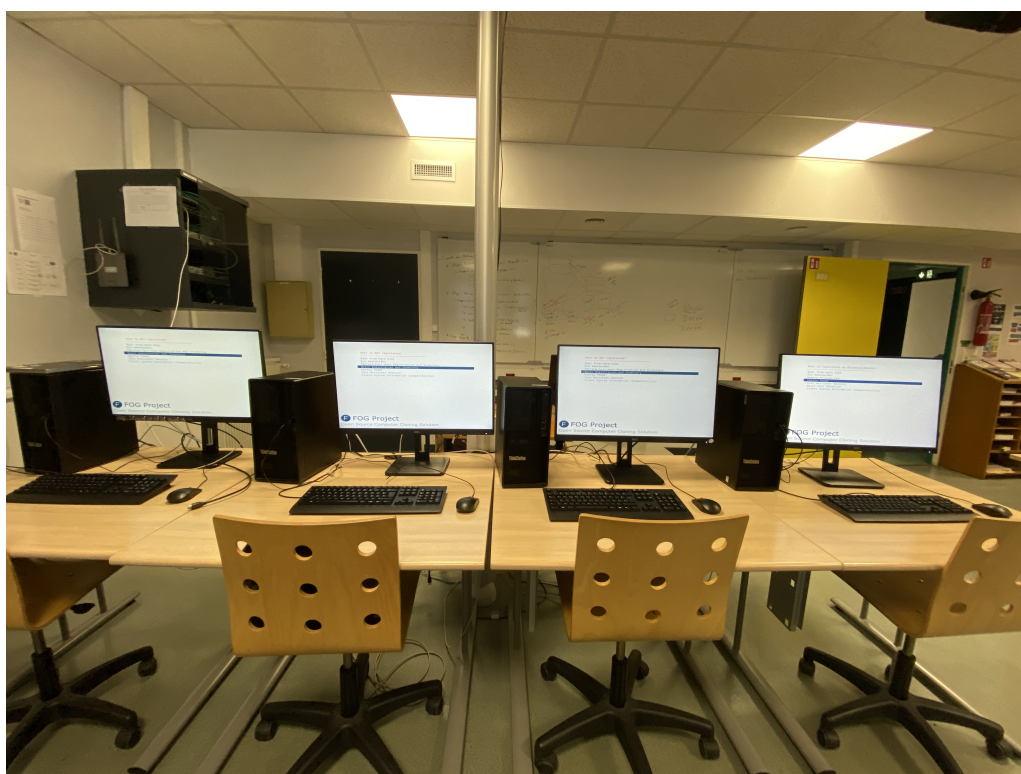
Les 4 postes d'une rangée de la salle 409 en cours de boot PXE — menu FOG affiché sur chaque écran
