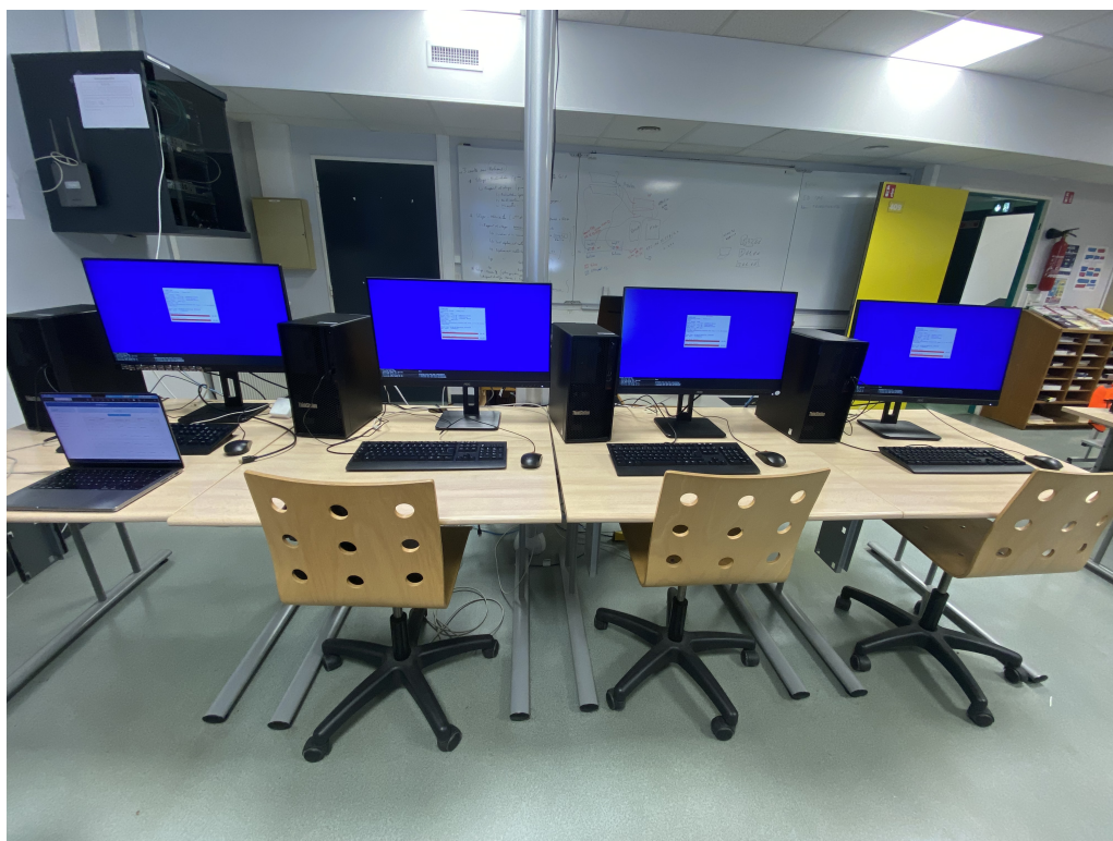
Déploiement multicast en cours — Partclone s'exécute simultanément sur les 4 postes de la rangée
